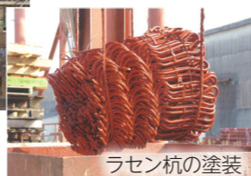
▲※2: ラセン杭は、農業用ビニルハウスのバンドを地面に固定する部材
