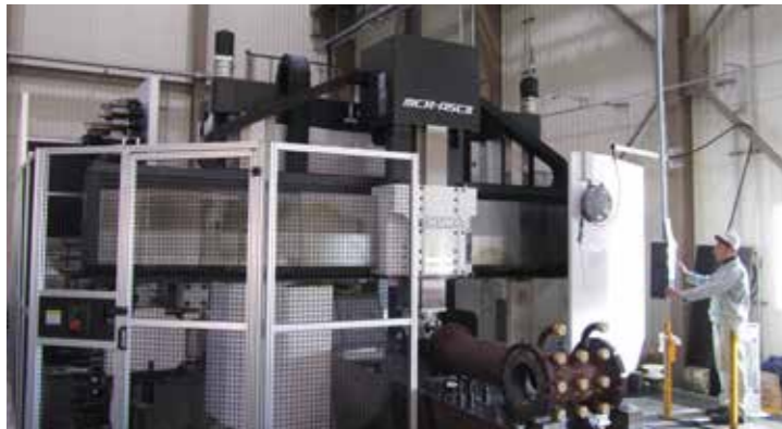
▲大津さんが操作する五面加工機(MCR-A5C II) この他にも、大型機械設備が多数あります
