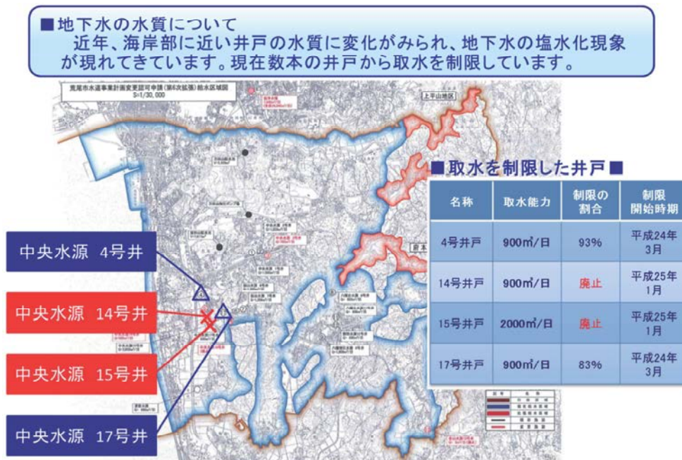
図 4-14 塩水化の進行によって取水が制限されている井戸
