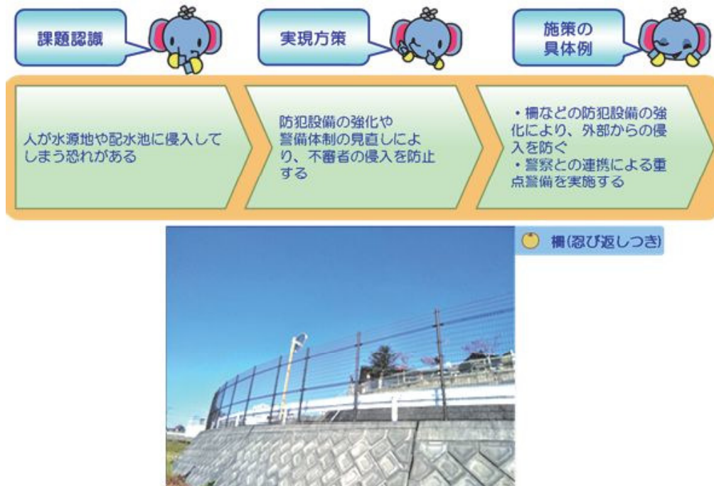
図 4-7 荒尾市の水道施設を守る設備
