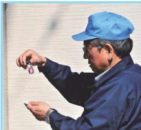
写真 3-2 : 水道水に試薬を混ぜ、塩素消毒が行き届い ていることを確認している風景
