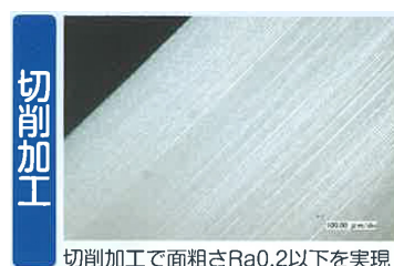
切削加工で面粗さRa0.2以下を実現
