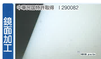
鏡面加工で面粗さRa0.01以下を実現
