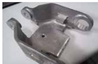
▲振動試験装置の部品となるマグネシウム加工製品
