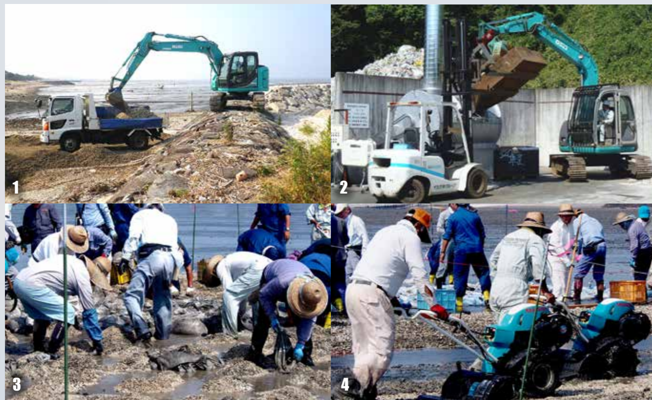
1_油圧ショベルを使って海岸の貝殻を収集します。2_ロータリーキルン(回転式の窯)を使って、400℃で貝殻を焼成します。焼成した後で破片の大小で選別します。3_焼成した貝殻を破片の大きさごとに実験場所を分けて干潟に散布します。酸性化した干潟の中和と、有害な硫化物を付着させる効果が期待できます。4_干潟の表層だけではなく、内部にも効果を及ぼすため、散布した貝殻を、干潟にすき込みます。
