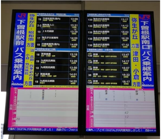
▲JR 日豊本線 下曽根駅構内に設置されている、バスロケーションシステムの例。利用者にとって、スムーズな乗継が可能となっている。
